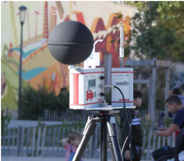
Mesures de micro-climat à l'aide d'un appareil de mesures multi-paramètres (température de l'air, température de globe noir, humidité, vitesse de vent) à Lyon (source : TRIBU)
